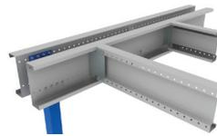
Uma união em L rígida assegura a ligação entre a viga principal e a viga secundária. As cargas da viga secundária são transferidas para a viga principal sem qualquer deformação da união.
